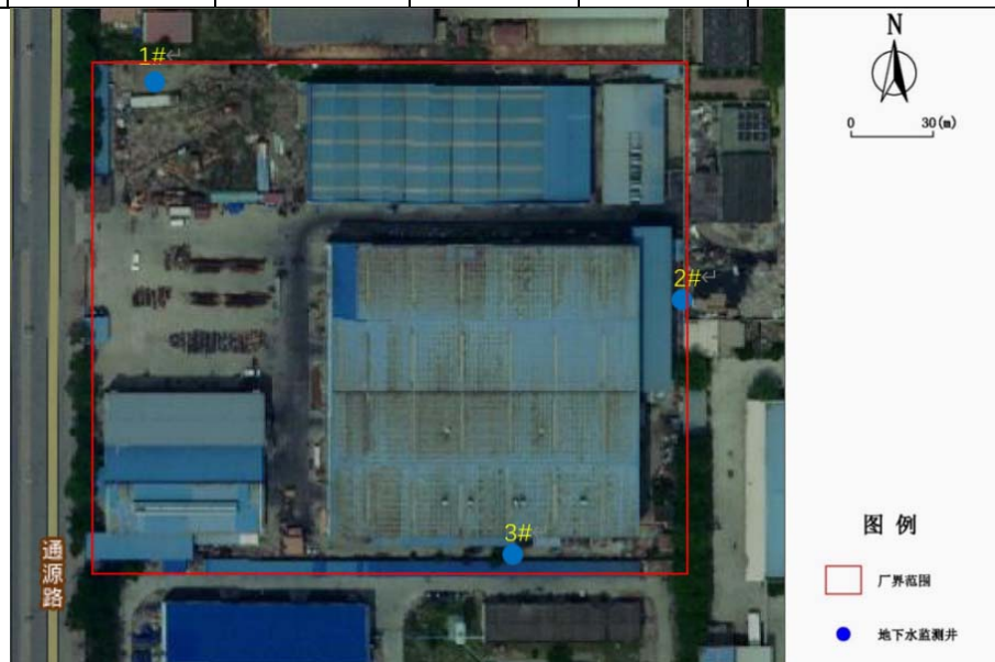
图7. 地下水监测井布置图
