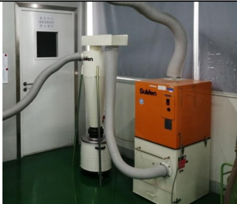
图 4.1-2 旋风分离+二级过滤除尘器示意图（上海工厂在用）
